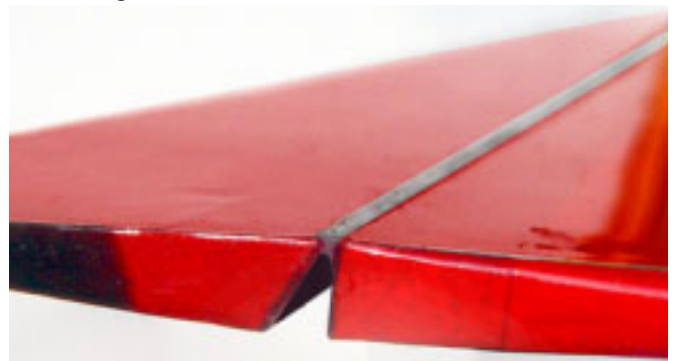
Hier das fertige Silikon-Ruderscharnier an einem gewöhnlichen, Oracover-Light bespannten, Rippen-Höhenruder.
