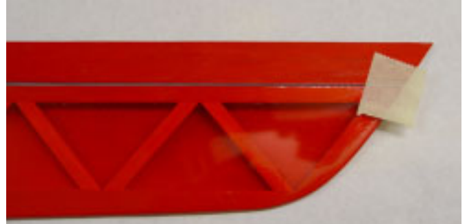
Ruder und Fläche mit Abdeckband fixieren. Abwechselnd links und rechts korrigieren bis 1-2mm Spalt vorhanden.
