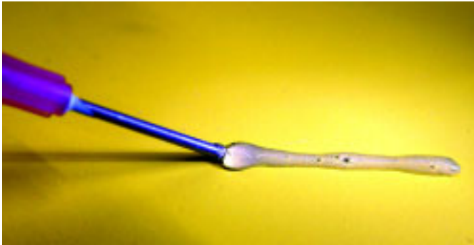
Silikon-Raupe mit Spritze und gekürzter 1,2mm Nadel ...
