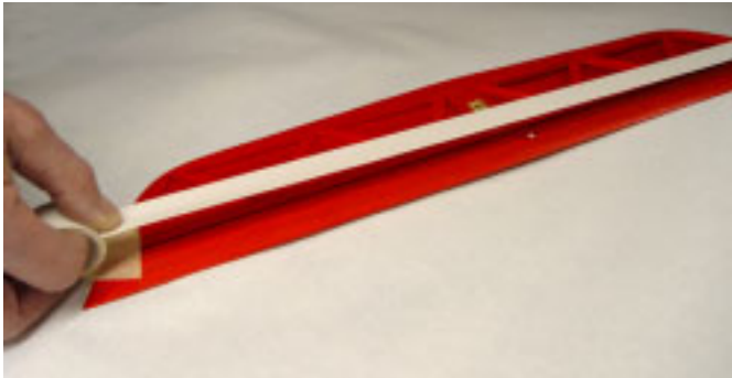
Mit stabilem (nicht zu weichem) Klebeband, (ev. 2-3 Lagen) Spalt überdecken und sehr gut andrücken.
