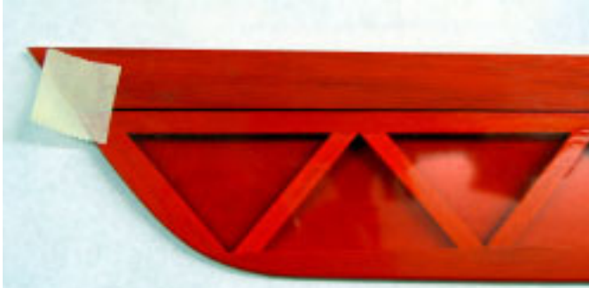
Ruder und Fläche mit Abdeckband fixieren. Abwechselnd links und rechts korrigieren bis 1-2mm Spalt vorhanden.
